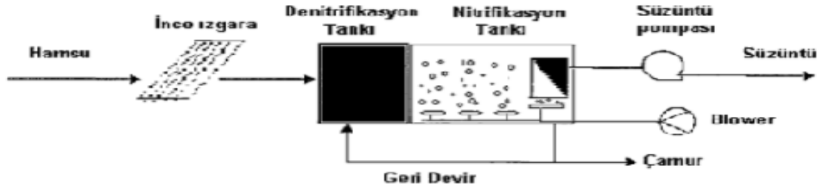
Şekil 25:Membran Biyoreaktör Genel Akış Diyagramı
