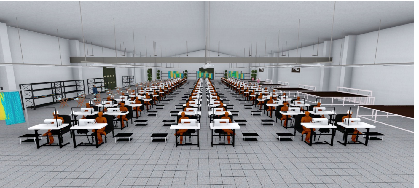
Resim 2 Tasarlanan Atölyedeki Örnek Makine Yerleşim Planı
